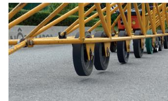
Die Ebenheitsmessungen auf der Bahn werden mit einem 4 m langen Planograph durchgeführt.
